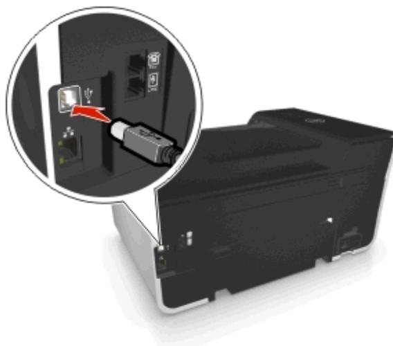
3 Conecte a extremidade retangular do cabo USB firmemente à porta USB do computador.
